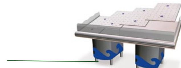
Mediante un novedoso sistema de bandejas conseguimos que el hielo permanezca sujeto a la exposición, evitando su desplazamiento hacia la parte delantera. A diferencia de otros expositores, con nuestro diseño ahorraremos energía y agua, pues con una capa menor de hielo conseguiremos exponer mejor el producto.
