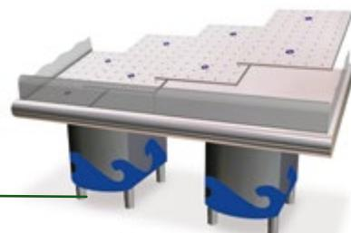
Mediante un novedoso sistema de bandejas conseguimos que el hielo permanezca sujeto a la exposición, evitando su desplazamiento hacia la parte delantera. A diferencia de otros expositores, con nuestro diseño ahorraremos energía y agua, pues con una capa menor de hielo conseguiremos exponer mejor el producto.
