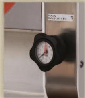
Réglage précis du laminage et de l'allongement
